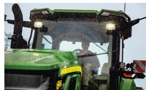
330° pokritost brisalca sprednjega vetrobranskega stekla
