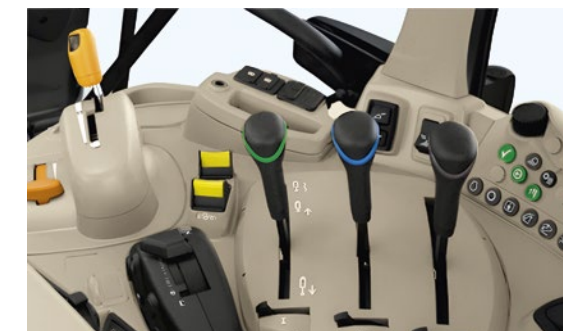
AutoPowr™ na konzoli na desni strani z mehanskimi ventili SCV
