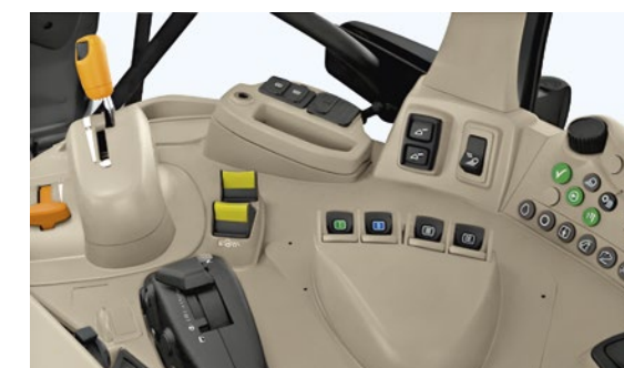
AutoPowr™ na konzoli na desni strani z električnimi ventili SCV
