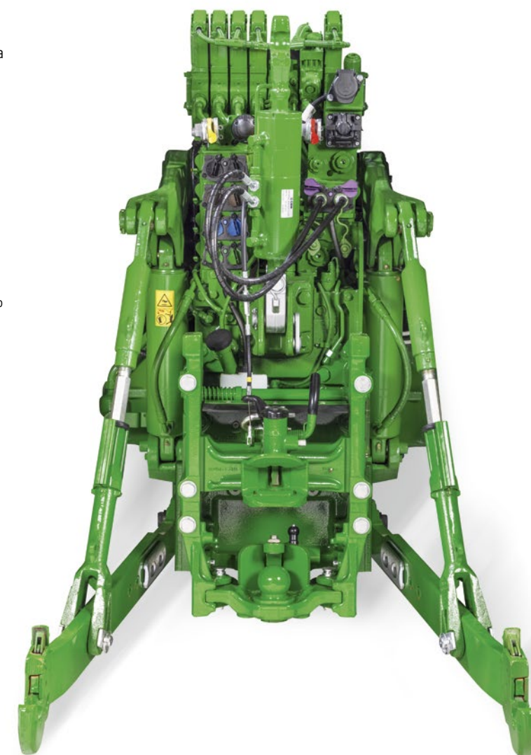
Samodejni in mehanski priklop prikolice z 38-milimetrskim krogličnim sornikom
